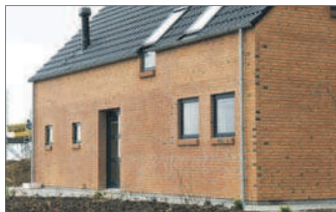
Det samme billede som til venstre, men uden undertryk. Nu ses overgangene mellem inddækning og væg kun som moderate kuldebroer.
