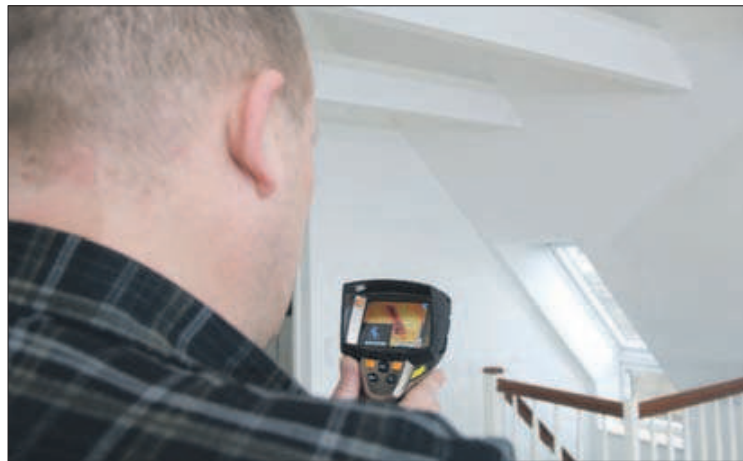
Termokameraet har en nøjagtighed på en tiendedel grad og afslører skånselsløst alle kuldebroer og skjulte mangler i isoleringen.
